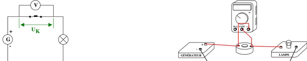
La tension circuit ouvert :  $U_K = 5,02 \text{ V}$
