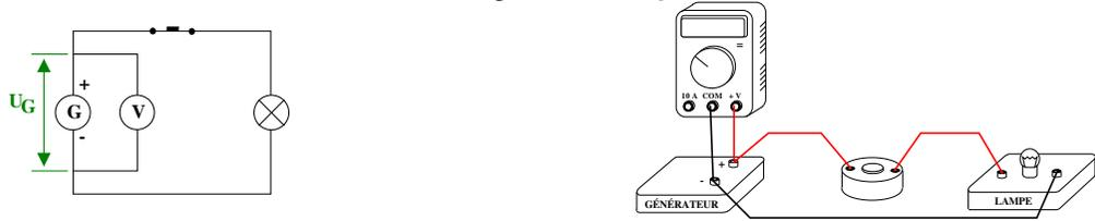
La tension circuit ouvert :  $U_G = 5,02 \text{ V}$
