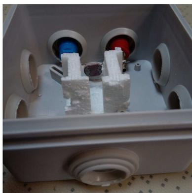
3 : Réaliser le montage expérimental. Une fois validé par l'enseignant, mesurer la résistance de la photorésistance pour chacune des solutions étalons. (Attention, il faut bien refermer le couvercle du dispositif)
